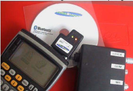
Bluetooth/RS232-Kit för bl.a. fjärrstyrning av totalstationer.
